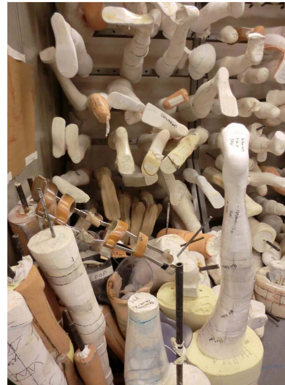
Wand met prothesemallen, POM Nijmegen, revalidatietechnieken
