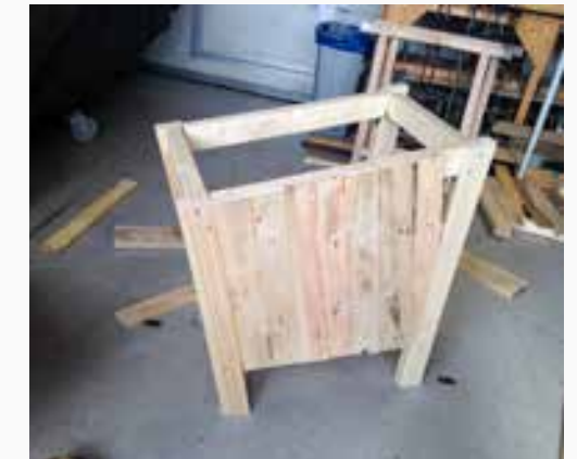
De bakken zijn gemaakt uit een mix van gevonden pallet hout en ingekochte balken
